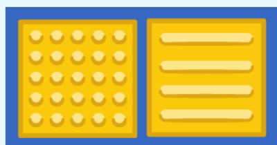
Sinalização tátil amarela em piso azul
